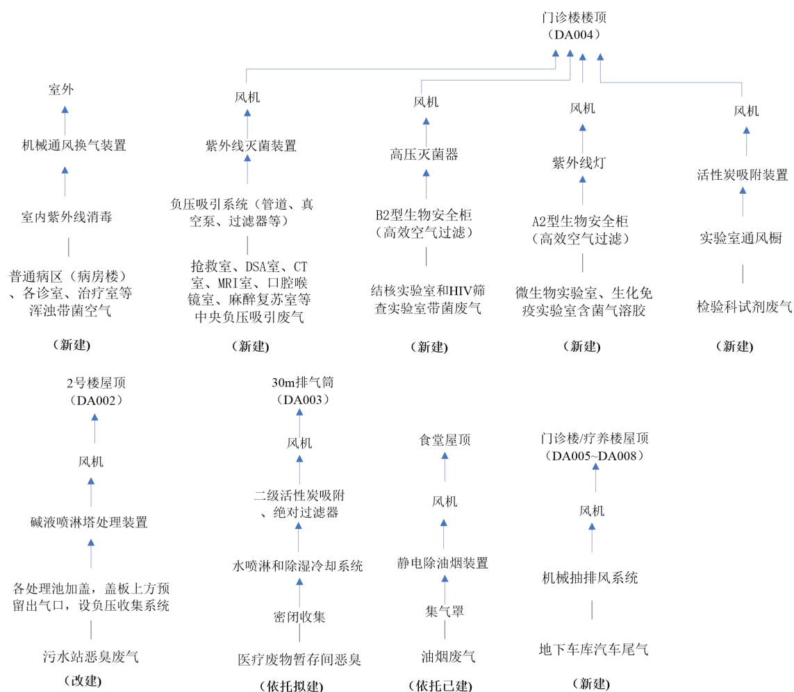
图 4-2 建设项目废气处理流程图
