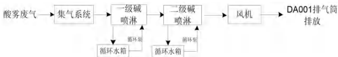
图 6-3 建设项目酸雾废气处理工艺流程图
