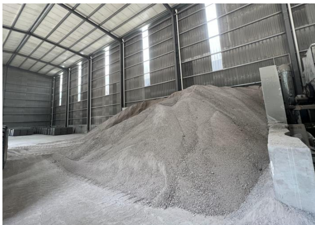
室内再生骨料临时堆场（靠墙配喷淋系统）
