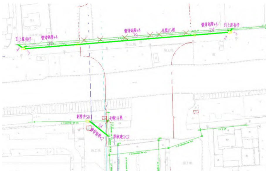
图 6-8 通信管道迁管改方案
