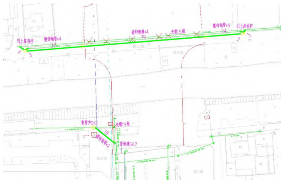
图 6-10 通信管道迁管改方案
