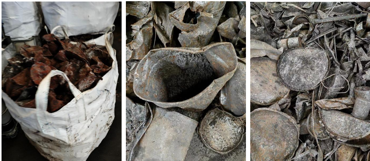
图 3.2-1 火烧铁实物照片
